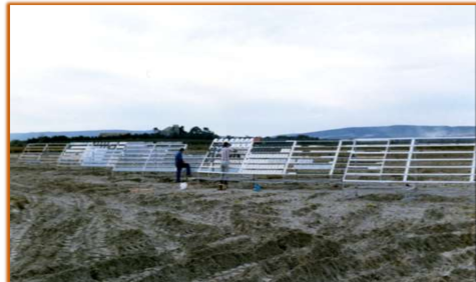
Site d'exposition en corrosion naturelle à Palavas, face à la mer (source : http://www.peinture-carrosserie-peugeot.com )
