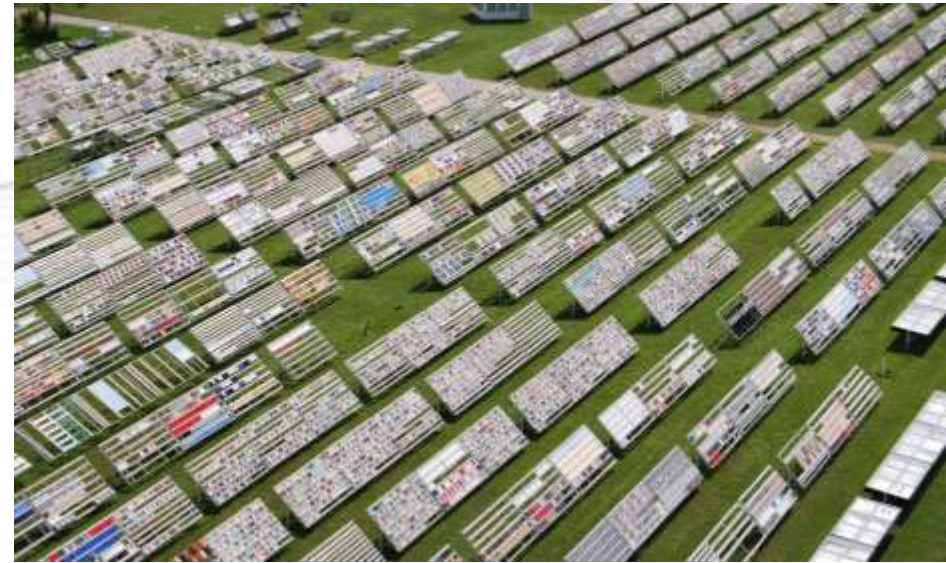
Site d'exposition naturelle en Floride (source : https://www.q-lab.com/fr-fr/test-services/florida.aspx )
