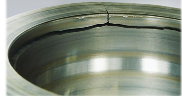
Bague extérieure d'un roulement à deux rangées de rouleaux cylindriques (document SKF)
