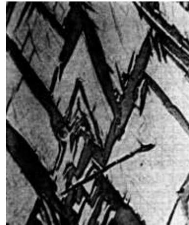
Aiguilles martensite (noir) dans matrice austénitique (x 1000)
