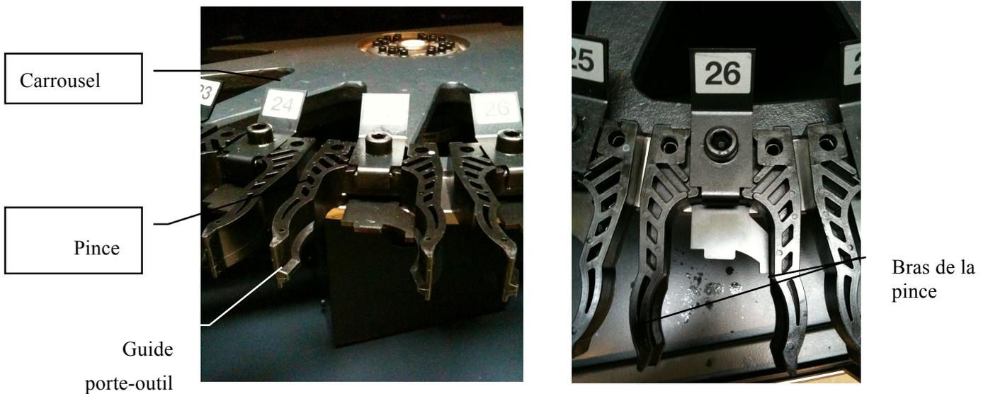
Figure 1 : Mise en situation de la pince et du magasin
