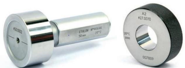
Cylindres, piges et bagues étalons : matérialise une cote de diamètre d'un cylindre extérieur ou intérieur
