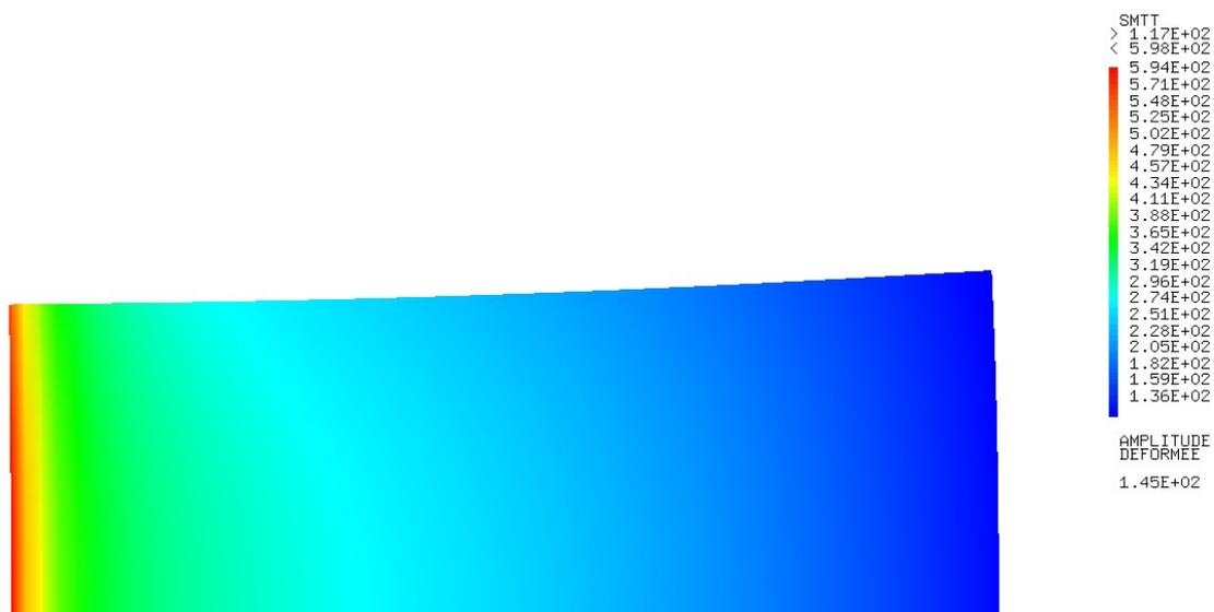
Figure 3 – Résultats éléments finis axi-symétrique :  $\sigma_{rr}, \sigma_{\theta\theta}$
