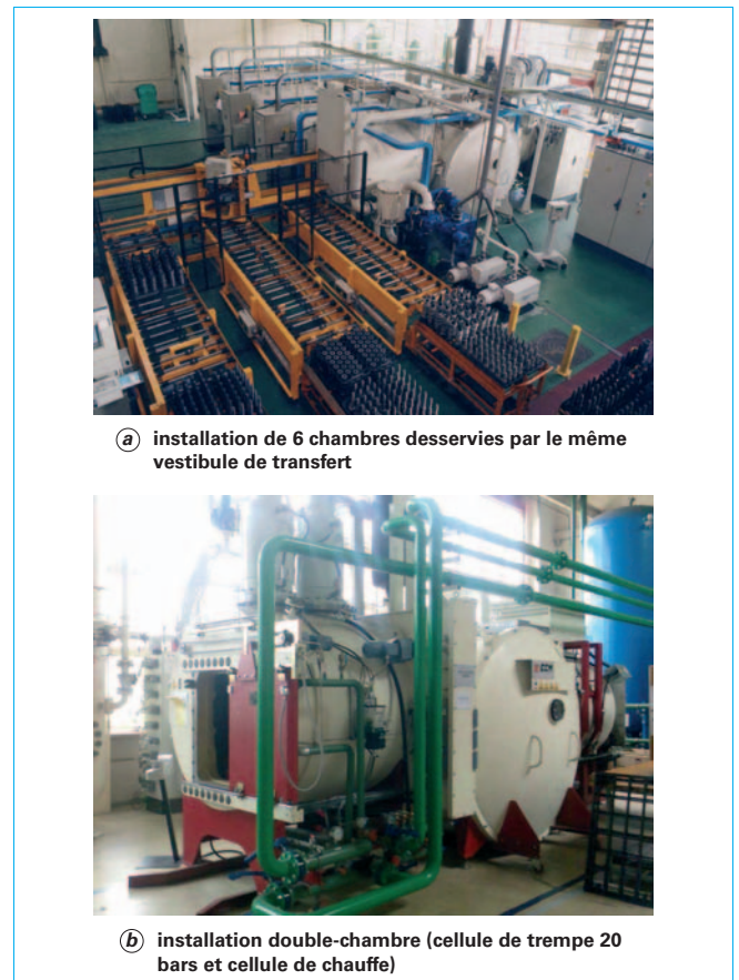
Figure 5 – Installations de cémentation sous basse pression (constructeur ECM)
