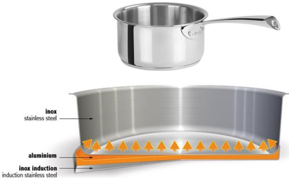
Figures 5. Casserole triple épaisseur (corps inox austénitique 18/10, aluminium et base inox ferritique)
