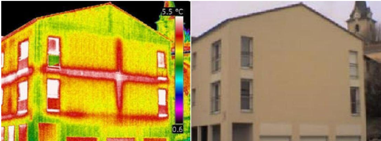
Figure 1. Thermique du bâtiment
