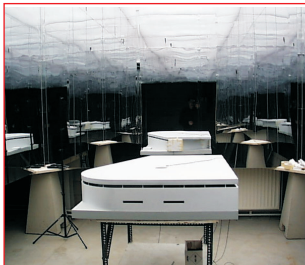
Mesures sous ciel artificiel au CSTC 1 (mirror box).
