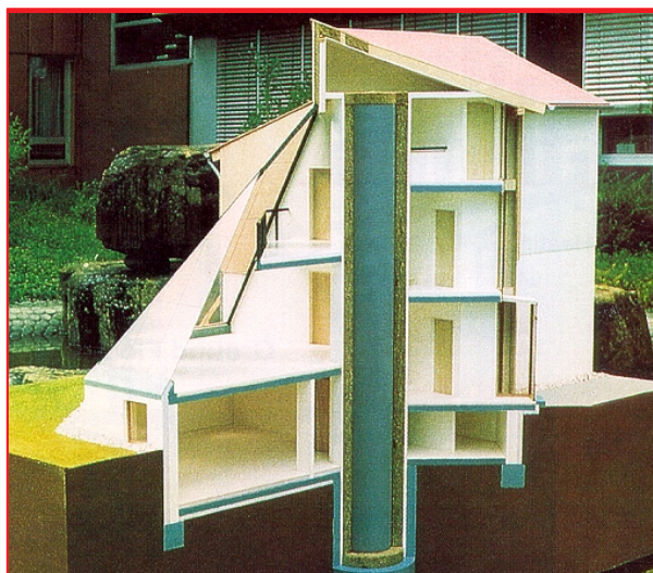
Maquette d'une maison basse énergie à Berlin. Un double réservoir central stocke la chaleur provenant des capteurs solaires.
