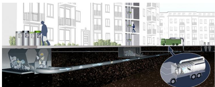
Figure 4. Système de collecte des déchets - Canalisations et Camions aspirants
