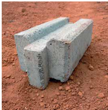
Profil de la brique ISSB
