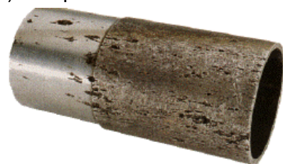
Corrosion par piqûres d'un acier inoxydable
