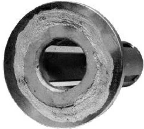
Corrosion par crevasse sous un joint
