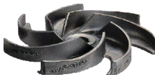
Corrosion-cavitation d'une aube de pompe
