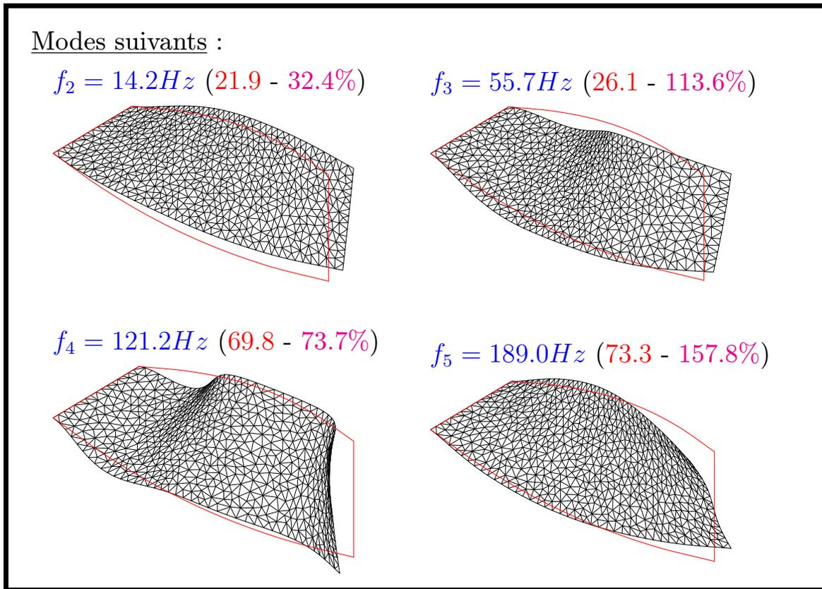
Les modes suivants sont eux complètement modifiés par cette nouvelle forme de la plaque. Compte tenu de la forme vrillée de la plaque, les modes sont difficilement identifiables comme mode de flexion ou de torsion (sauf le mode 5, qui est un mode de torsion).
