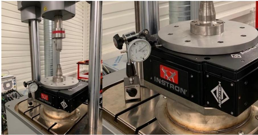
Figure 11 : Positionnement du comparateur sur la machine pour la mesure A
