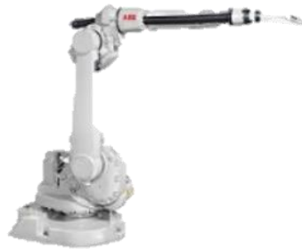
Un robot ABB polyarticulé 6 axes et ses commandes
