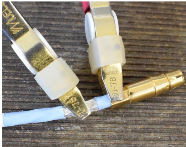
Figure 12 - Mesure de résistance entre fût et tresse d'un prototype K4
