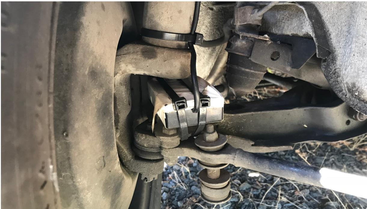
FIGURE 27 : EMBLACEMENT DU BOITIER DE MESURE N°1
