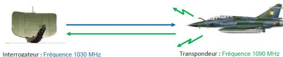
*Figure 6 : Principe du système IFF*
