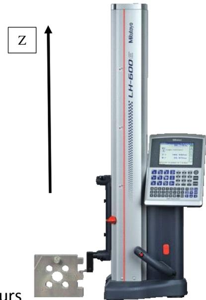
L'accès au point intérieur ou extérieur se fait par des palpeurs de diamètres différents
