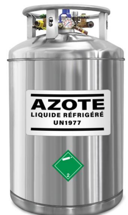
Figure 4. Vase de Dewar pour azote liquide
