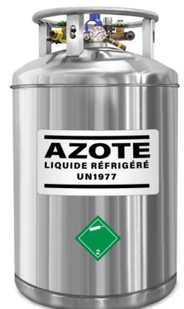
Figure 4. Vase de Dewar pour azote liquide
