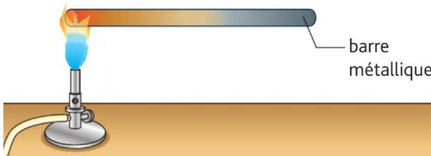
**Figure 21.** Transfert thermique par conduction
