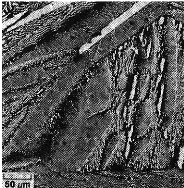
Microstructure d'une fonte blanche
